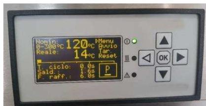
Il display mostra i parametri di saldatura impostati (tempo di riscaldamento, temperatura, tempo o temperatura di raffreddamento) e ne consente la variazione direttamente dallo schermo senza bisogno di accedere ai sottomenu.
